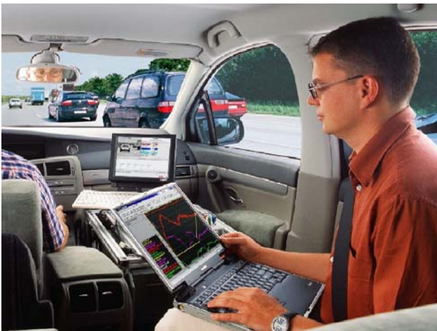
Abb.3: Entwicklung der elektronischen Steuersysteme bei Bosch, Feinabstimmung auf Testfahrten (Quelle: Bosch)
